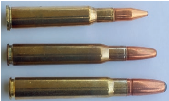
Naboji u tri različita kalibra, s različitim konstrukcijama i masama zrna, prikladni za različite vrste lova i različite veličine divljih svinja
